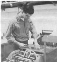
HORNKOHL, LI3, adjusting 1250 Multilith Press
